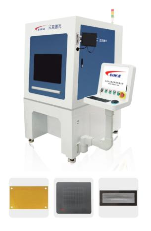
本机采用高精度直线电机平台,确保整机高速高精度稳定运行;可选配 CCD 视觉定位功能,可简化加工工艺;专业的激光切割软件,具有图形排样及尖角平滑处理功能,精度高、热影响小,可实现高速切孔及标刻功能。
